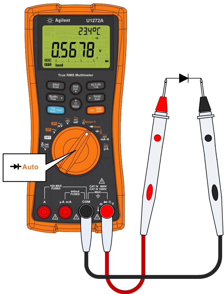
图 2-20 测试正向偏压二极管
