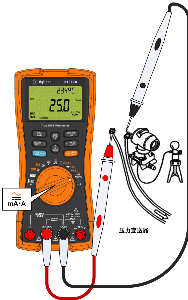
图 2-34 使用 4-20 mA 百分比刻度测量 DC 电流
